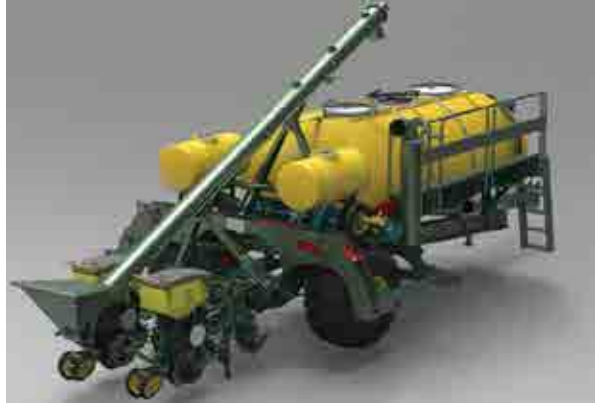
Şekil- 4. Montaj ortamları ile oluşturulmuş bir tarım aleti tasarımı (Solid Edge)
