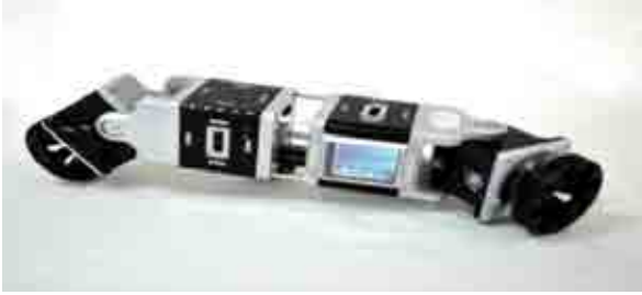
Şekil 2. Modüler yapılandırılabilir robot OMNIMO'nun fotoğrafı
