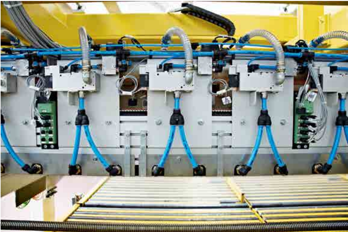
Yüksek performans: 105 vakum valfi vakumu hassasiyetle dağıtır.
