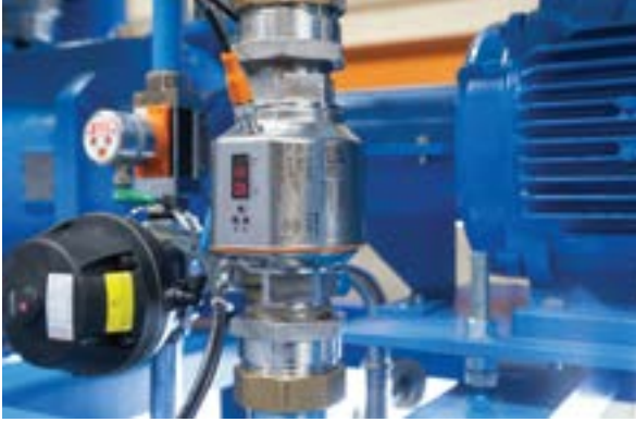
akışı kontrol ederler. Bu sensörler IO-Link donanımlıdır.
