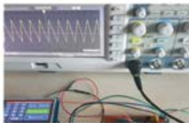
Şekil 9. Üçgen dalga çıkışı
