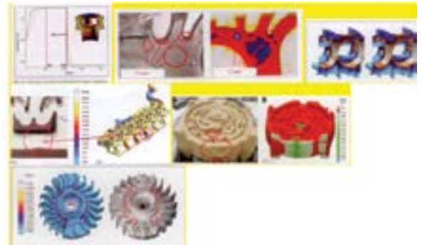
Şekil 46: Isıl işlem süresi, çatlak simülasyonu, sıcak kırılma, maçadaki iç gerilim maçada emme, maça sandığı doldurma simülasyon örnekleri
