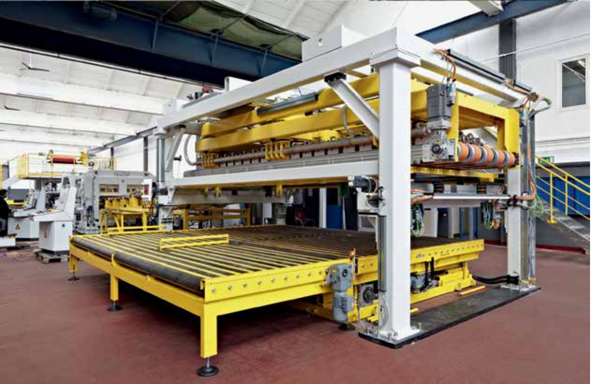
Formda metal levhalar: Kohler'in 42 metre uzunluğunda tesviye sistemi, dakika başına 80 m sacın gerginliğini kaldırır.
