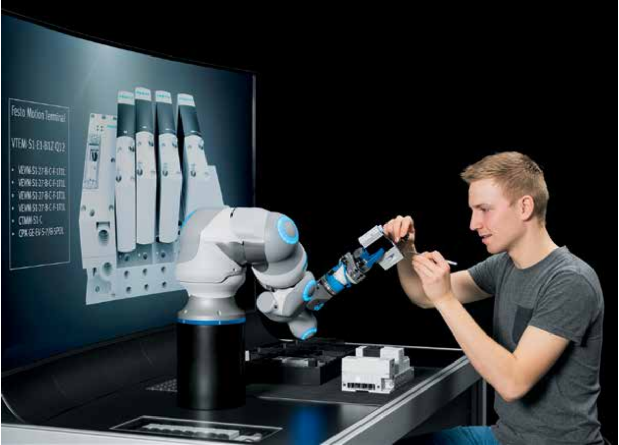
BionicCobot: İnsan-robot işbirliğinde hassas bir yardımcı olarak insan hareketi modellerine sahip pnömatik hafif robot
