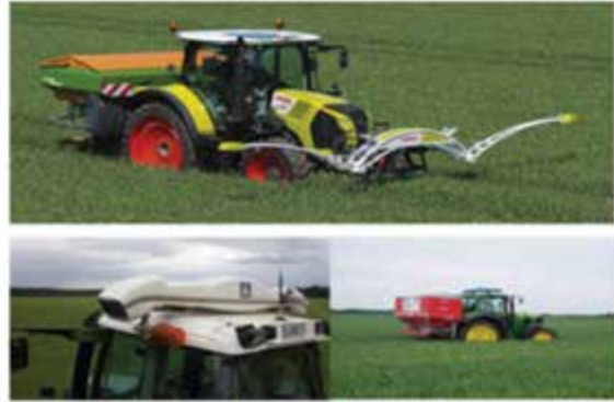
Alana özgü sensör tabanlı gübrelemede kullanılan Led'li(üstte), aktif ve pasif 3 teknolojik sistem
