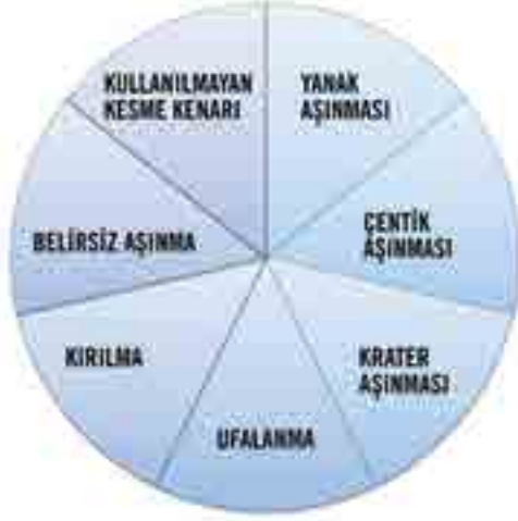
Şekil 6: Kesici takımlar farklı olgular nedeniyle aşınır
