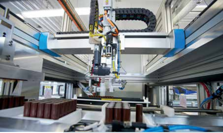
Festo EXCH yatay köprülü gantry eksen ile yüksek hızlı batarya hücresi seçme ve yerleştirme.
