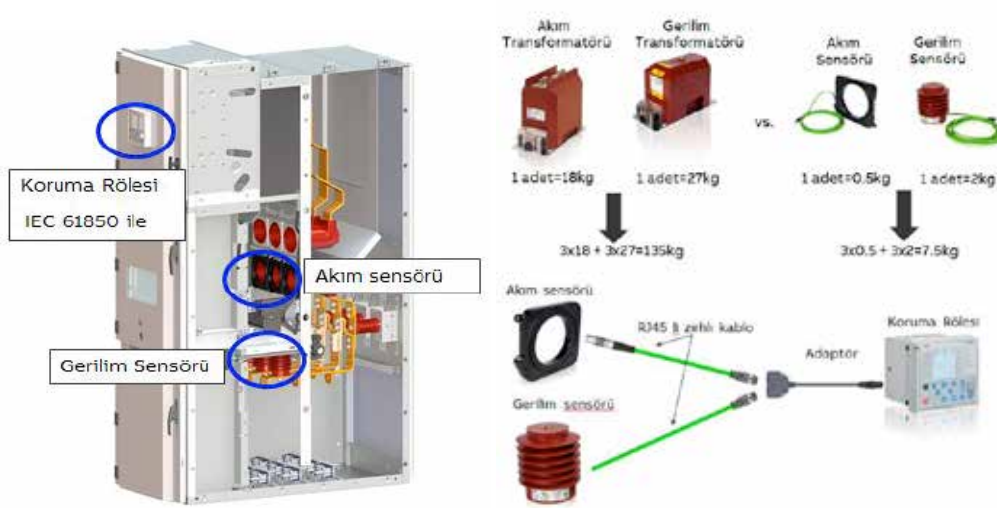
Şekil 6: AIS panolarda akım-gerilim sensörlerinin kullanılması
