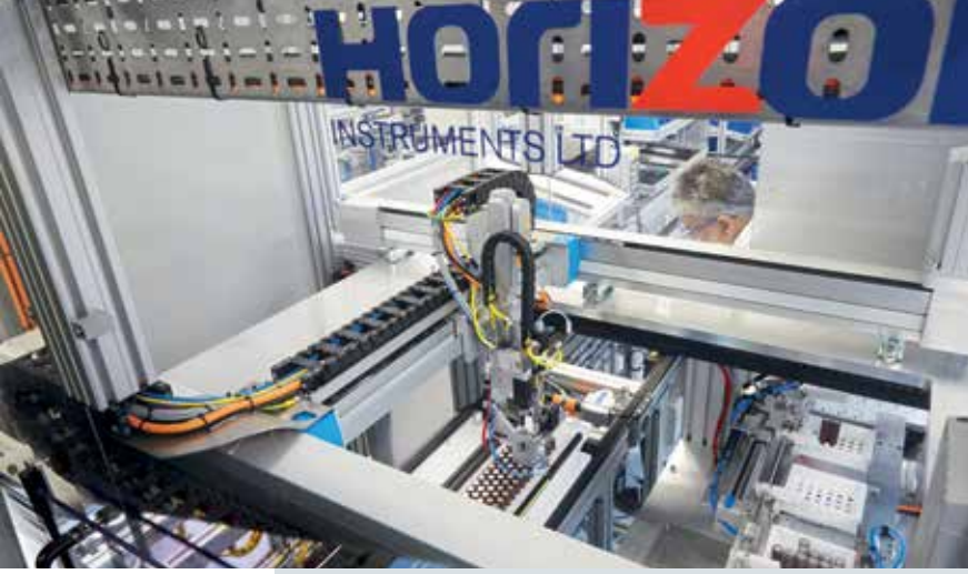
Otomasyon çözümleri uzmanı Festo, Horizon Instruments için yatay köprülü gantry eksen tasarladı ve entegre etti.
