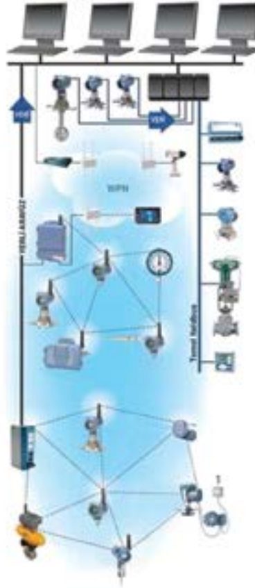
Şekil 3. Kablosuz ağlar kablolu ve kablosuz saha cihazlarına bağlanmayı mümkün kılıyor; böylece bir çok cihazın arayüzlerinden gelen veriler çeşitli işletim uygulamaları için erişilebilir hale geliyor. Foto: Emerson Process Management
