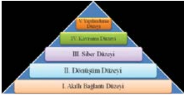
Şekil 2. Siber Fiziksel Sistem Kurulumunda 5C Mimarisi
