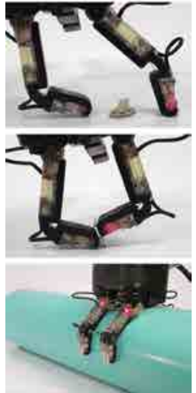
Şekil 6. Üst ve orta: iHY eli, anahtarı kaldırmak için onu "kısaç tutuşu"na sokuyor. Alt: Bu uzunluktaki bir boruyu kavrayabilmek için üç parmak kullanan "kavrama tutuşu" gerekiyor.
