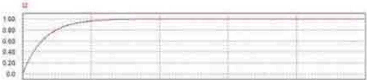
Şekil 2. L elemanının doğru akımdaki akım dalga şekli
